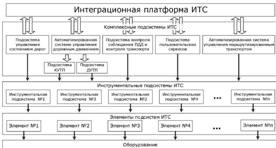
Рисунок 7.3.2 – Обобщенная физическая архитектура ИТС.
