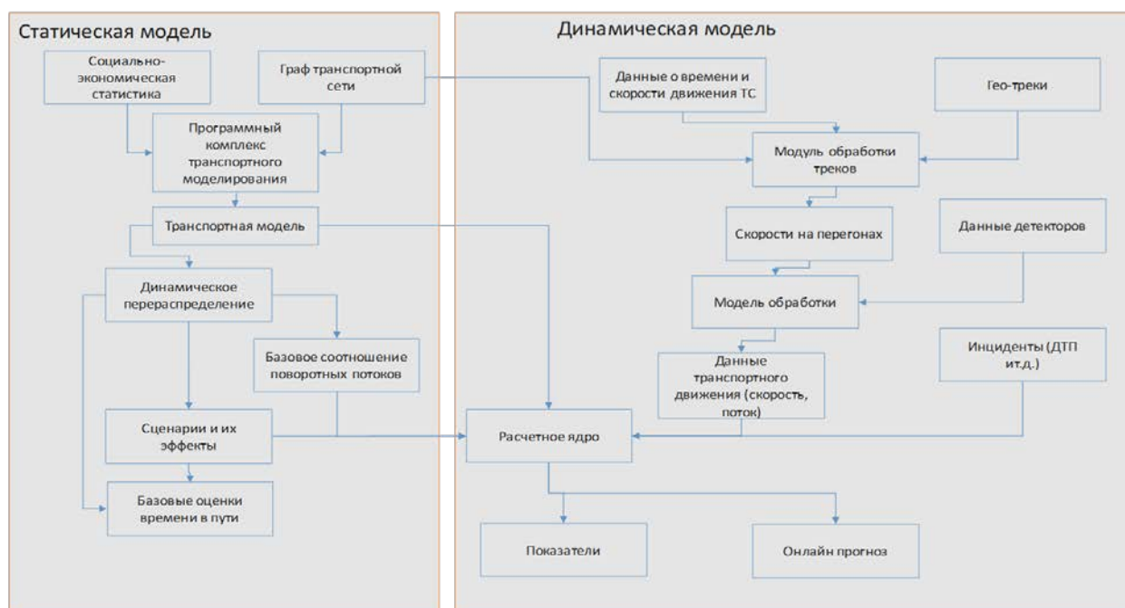
Рисунок 4.8.2 - Общая схема работы системы мониторинга в реальном времени.
